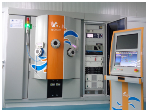
Високовакуумна система за оптични покрития Symphony 9
