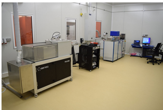
Системите Beneq TFS 200 за ALD и Oxford Nanofab Plasmalab System 100 за PE CVD в Бялата стая на Нанотехнологичния център към ИФТТ
