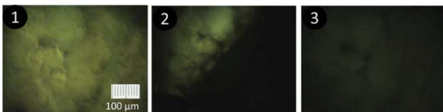
Фиг. 59. Микроскопско изображение, направено в режим на тъмно поле: 1) нематична фаза; 2) преход нематична-изотропна фаза; 3) изотропна фаза. Обектив \times 25 , големина на изображението 530 \mu\text{m} \times 400 \mu\text{m} .
