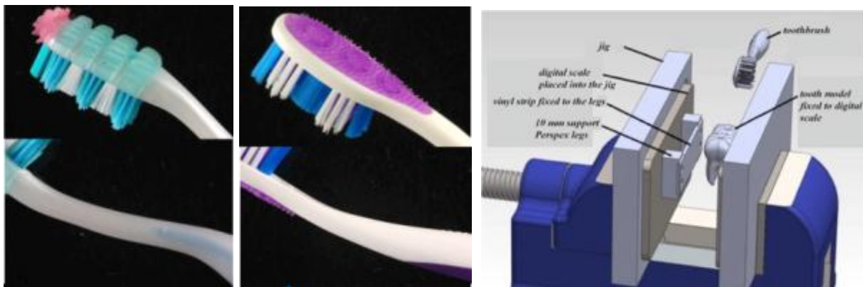
Фиг. 18. Изглед на тестваната четка за зъби (ляво) и контролната четка (в средата), за почистване на модел на бузите/езика и едновременно с това на зъбите. Показана е и схема на експеримента (дясно).
