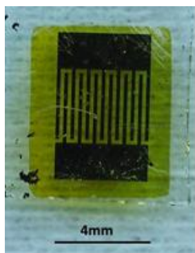
Фотодетектор на базата на тънък слой от \text{Zn}_{0.8}\text{Cd}_{0.2}\text{Se} , изработен в рамките на ЕБР проект с ИМТ, Букурещ, Румъния.
