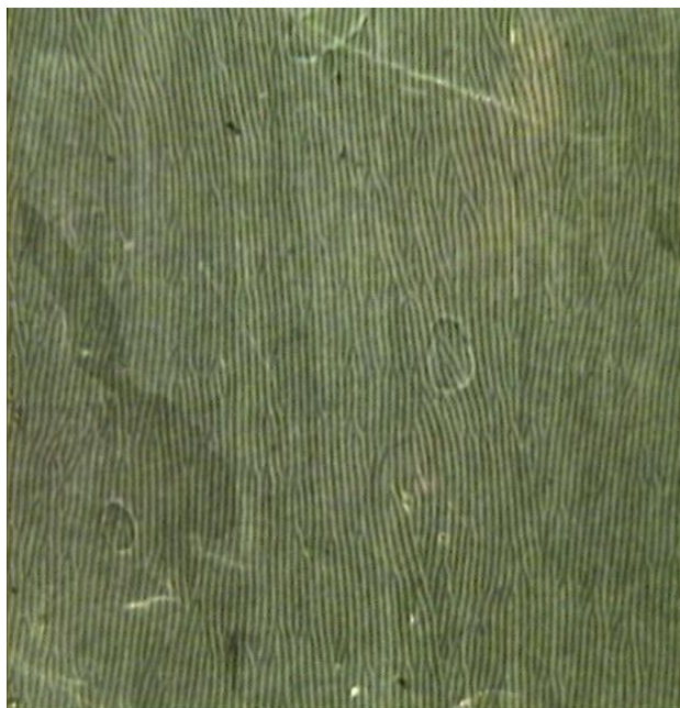
Фигура 47. Флексоелектрични домени получени при възбуждане с постоянно напрежение в поляризирана светлина, при леко разкръстени поляризатори: U_c = 20 V_{dc} . Виждат се много дефекти.
