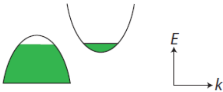
Фиг.1. Енергията на електрона като функция на k_x компонентата на момента. Горната зона е проводимата, а долната – валентната зона. Препечатано от arXiv:1005.4392v2
