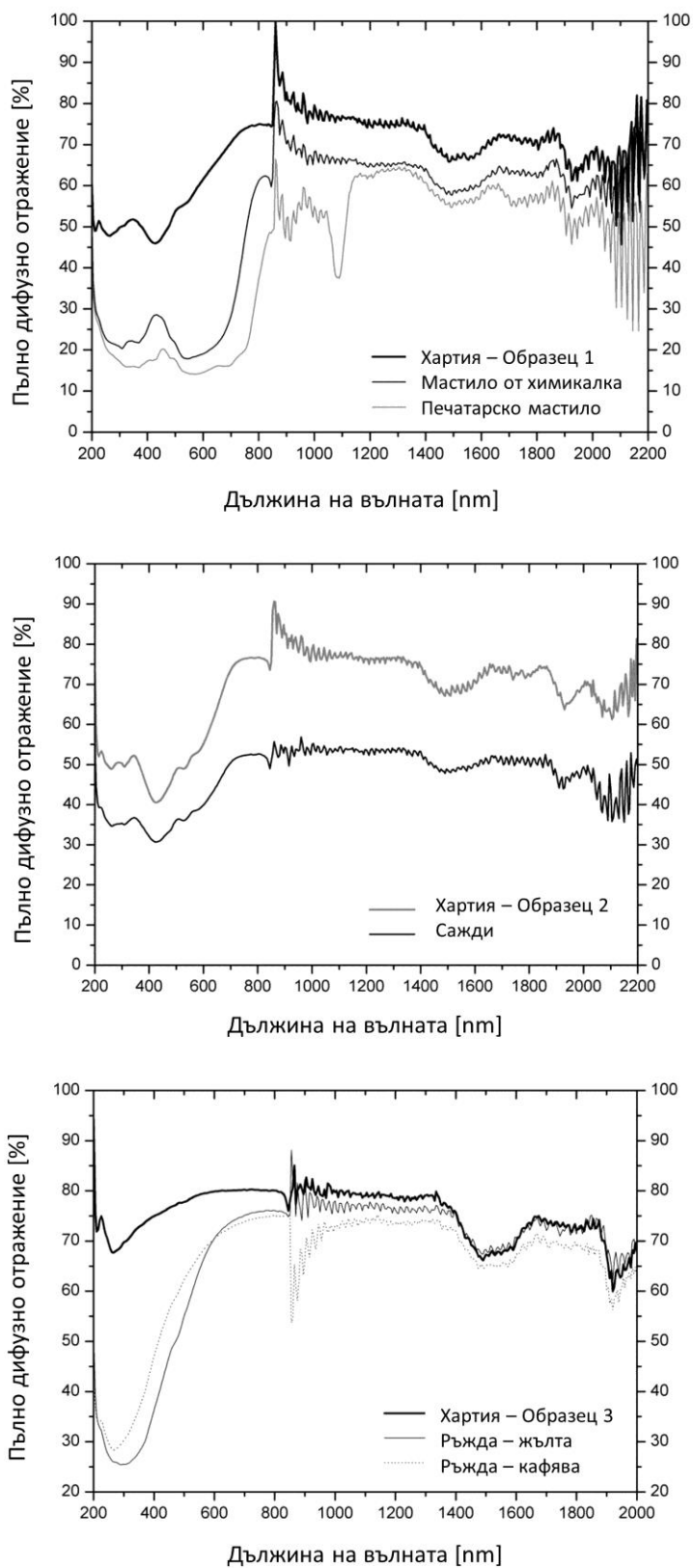
Фиг. 13. Спектри на пълно дифузно отражение от полу-сфера на мастилата, саждите, ръждата и хартията.
