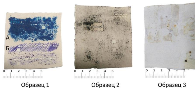
Фиг. 12. Опитни образци от хартия: Образец 1 – А) печатарско мастило, Б) мастило от химикалка; Образец 2 – сажди; Образец 3 – ръжда.
